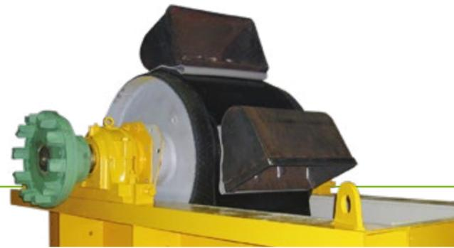
Zum stetigen Senkrechtfördern von schöpfbaren Schüttgütern eignen sich Gurtbecherwerke besonders. Grobkörnigen oder temperaturbelasteten Fördergütern wird durch geeignete Maßnahmen Rechnung getragen.
