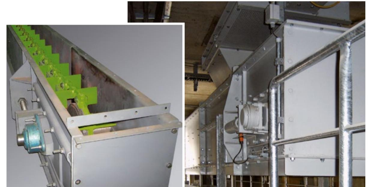
Die Antriebsstation hat je nach Baugröße Flansch- bzw. Stehlagler zur Aufnahme der Antriebswelle. Zur Abdichtung dienen nachschmierbare doppelte Radialwellendichtringe. Die gesamte Station mit Schauklappe ist komplett demontierbar und somit wartungsfreundlich. Der Antrieb besteht aus einem Getriebemotor oder einer Getriebe-Normmotor-Einheit auf seitlich angeordneter Konsole. Zur Vermeidung von Überlasten können entsprechende Sicherheitskupplungen vorgesehen werden.
